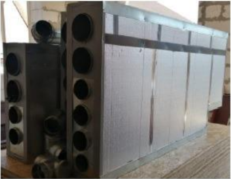
Шахты заводского изготовления
